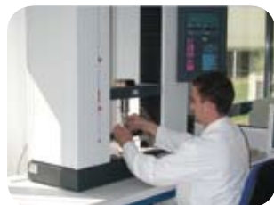
Abbildung 12 und 13 Kontrolle der Biegefestigkeit bei jeder einzelnen Produktionsauflage (Quelle RTD)
