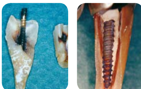
Abbildung 4 Foto eines korrodierten Stifts (Quelle Prof. Pier Nicola Mason)
